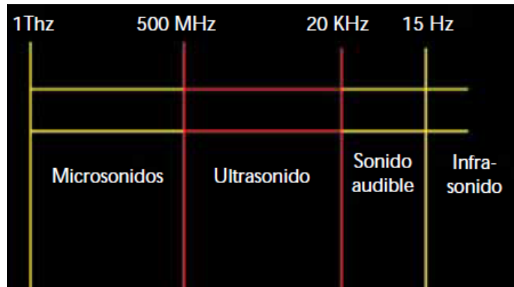
Figura 1. Espectro de vibraciones acústicas, la gama de frecuencias audibles por el oído humano ocupa un porcentaje muy bajo. A su vez, las vibraciones ultrasónicas forman parte de este espectro.
